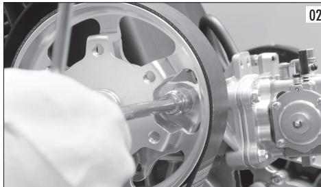
Posizionamento dell'asta di tensionamento:
