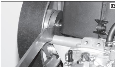
De la partie contraire du levier se trouve une autre partie courbe sur laquelle il faut mettre un poids de 6kg. Si vous n'avez pas ce poids, utiliser un bidon de 6 litres qu'il faudra remplir jusqu'à la réalisation du poids. C'est très important de respecter ce poids (photo 4).
