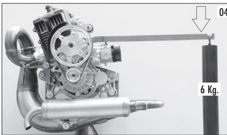
**ATTENTION IMPORTANTE** - Entretien et contrôle mise en tension courroie.
